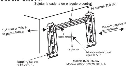
**Nota:** La forma de su placa de montaje puede ser diferente de la anterior, pero el método de instalación es similar.
