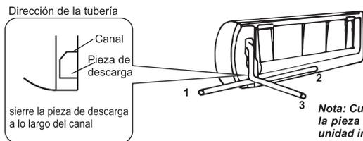
**Nota:** Cuando instala el tubo en la dirección 1 ó 2, sierre la pieza de descarga correspondiente de la base de la unidad interior.
